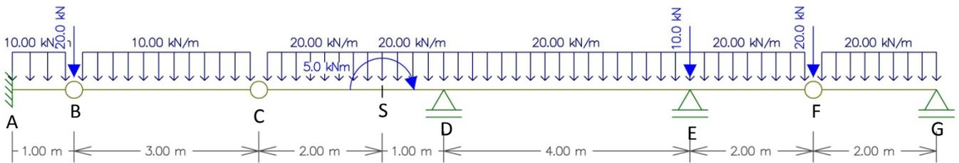
Desmembrando a viga, substituem-se as rotulas pelas forças correspondentes:
